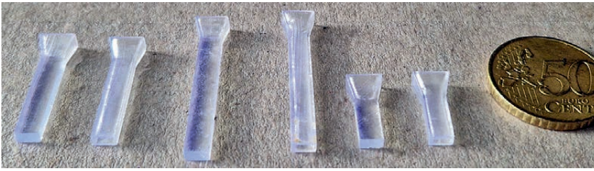
Abb. 3 Optische Wellenleiter mit unterschiedlichen Querschnittsgeometrien.
