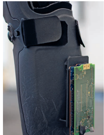
Abb. 7 Elektronikeinheit in Verbindung mit der Orthese.
