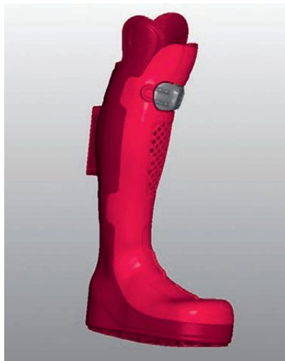
Abb. 1 Konstruierte Unterschenkelentlastungsorthese mit Hilfe der Software Freeform.
