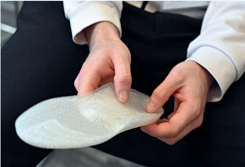
Verschiedene Shore-Härtegrade in einem Produktionsschritt sind dank 3D-Druck möglich und fühlbar.
