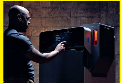
SLS-Drucker wie der Formlabs Fuse benötigen keine Stützstrukturen.
