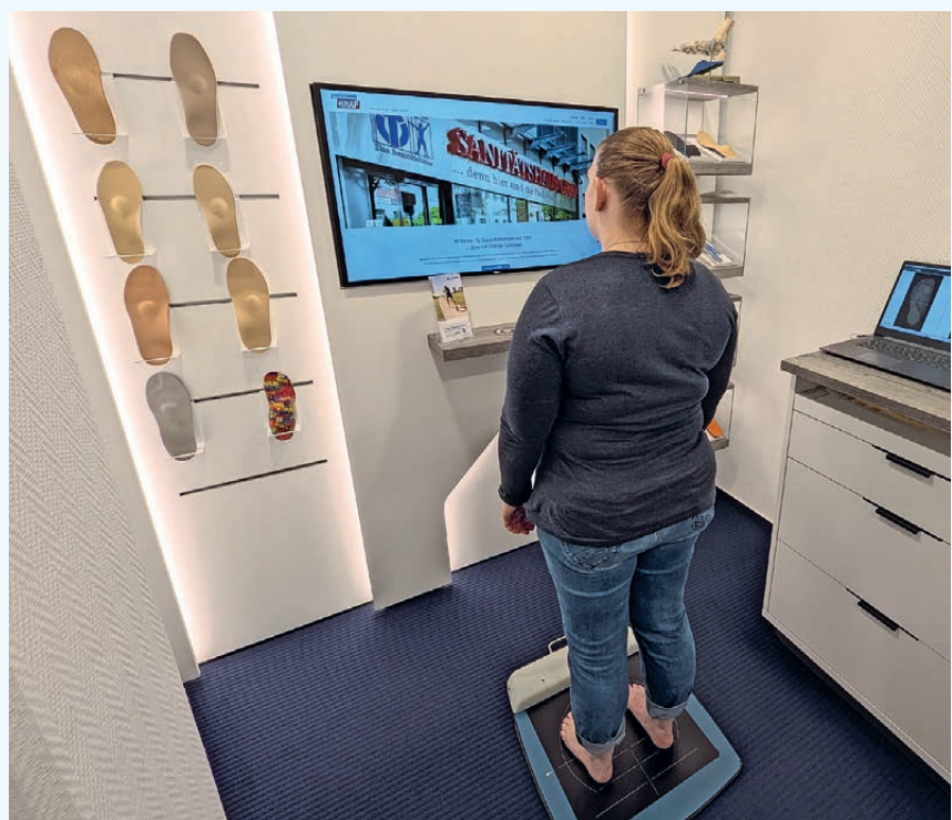
Die Druckmessplatte erhebt wichtige Daten für die Konstruktion.
