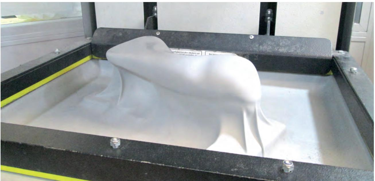
Abb. 3 Tiefziehen der erwärmten Materialien über das bearbeitete Modell.
