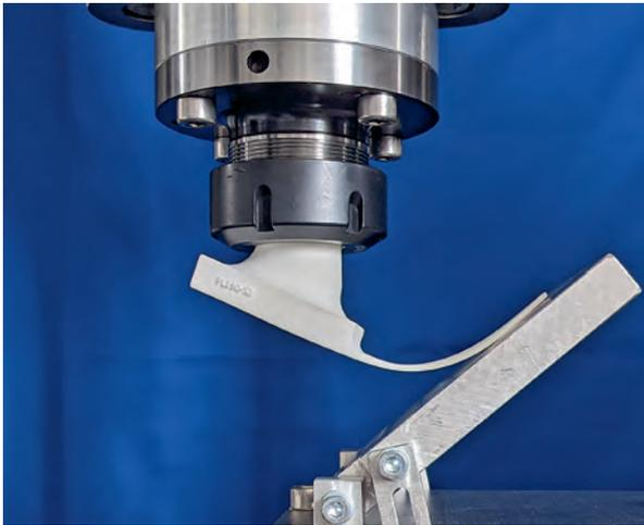
**Abb. 5** Testaufbau gemäß DIN EN ISO 10328 zur dynamischen Prüfung des Vorfußbereichs der Unterschenkelorthese mit einer Million Lastzyklen.
