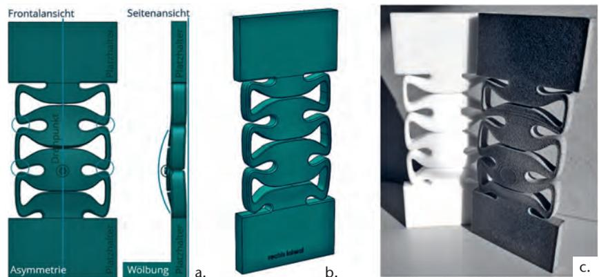
Abb. 5a-c Finales Basismodell des entwickelten Bewegungselementes als CAD-Modell (a u. b) mit Kennzeichnung einiger geometrischer Besonderheiten (a) sowie nach additiver Fertigung mittels SLS- (weiß) bzw. MJF-Verfahren (grau) (c).
