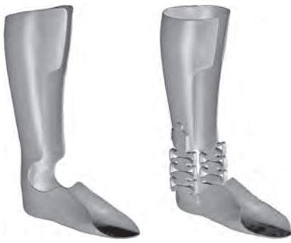
**Abb. 1** Traditionell (ORD) (links) und additiv gefertigte Unterschenkelorthese (rechts) im CAD.
