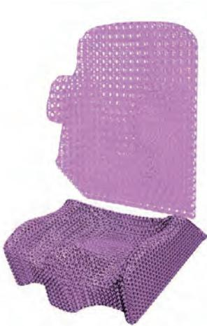
Der Einsatz von digitalen Fertigungstechniken wie Softwaredmodellierung und Scannen hat sich in der modernen Sitzschalenherstellung durchgesetzt. Das Modell wird jedoch konventionell aus einem Schaumstoffblock herausgefräst – hier kann der 3D-Druck eine innovative Alternative aufzeigen. Das VitalCentrum Hodey KG und BASF Forward AM geben Einblicke in ihre gemeinsame Entwicklung:
