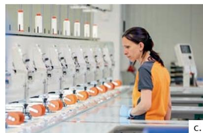
**Abb. 2a–c** Prozess des Tailored Fiber Placement (TFP): **a)** Prinzipskizze; **b)** reale Preformfertigung; **c)** industrielle TFP-Anlage mit mehreren Legeköpfen (Bildquelle: Hightex Verstärkungsstrukturen GmbH).
