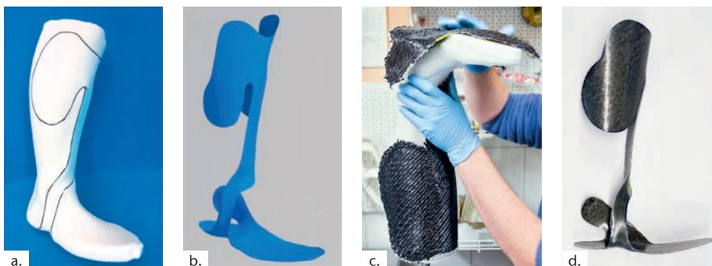
**Abb. 5a-d** Orthese mit komplexer Geometrie – vom digitalisierten Gipsmodell zum fertigen Bauteil.
