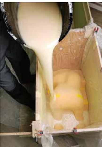
Fig. 7 Colada de la carcasa interior con modelo positivo.
