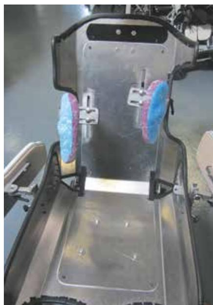
Fig. 8 Fabricación de la estructura exterior con placa intermedia y bisagras.
